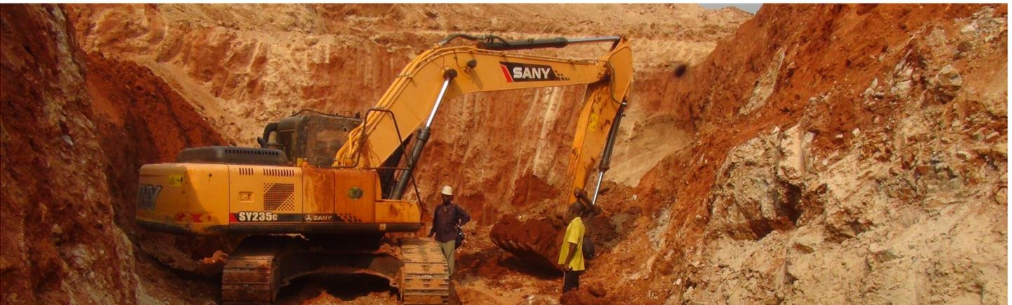
Découverte et excavation. *Une pelles de location combine les deux opérations à la mine de Trémie 7*
